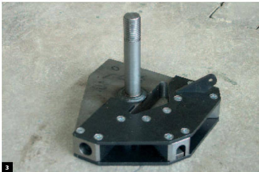
**Figura 3\_**Nudo di estremità inferiore assemblato
