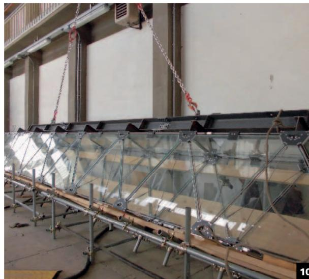
In seguito al posizionamento della trave sugli appoggi, questa è stata sottoposta a monitoraggio costante al fine di valutare gli effetti delle condizioni ambientali di temperatura ed umidità sul livello di presollecitazione a causa del comportamento visco-elastico del materiale polimerico di interstrato e di interposizione (Figura 9, Figura 10).
