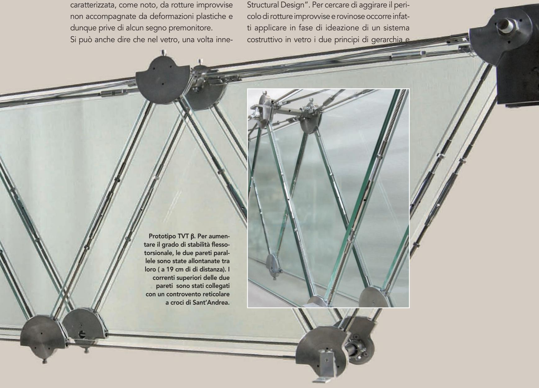
Prototipo TVT  $\beta$ . Per aumentare il grado di stabilità flessor-torsionale, le due pareti parallele sono state allontanate tra loro (a 19 cm di distanza). I correnti superiori delle due pareti sono stati collegati con un controvento reticolare a croci di Sant'Andrea.
