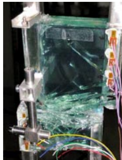
Fig. 4 - Rottura del campione
