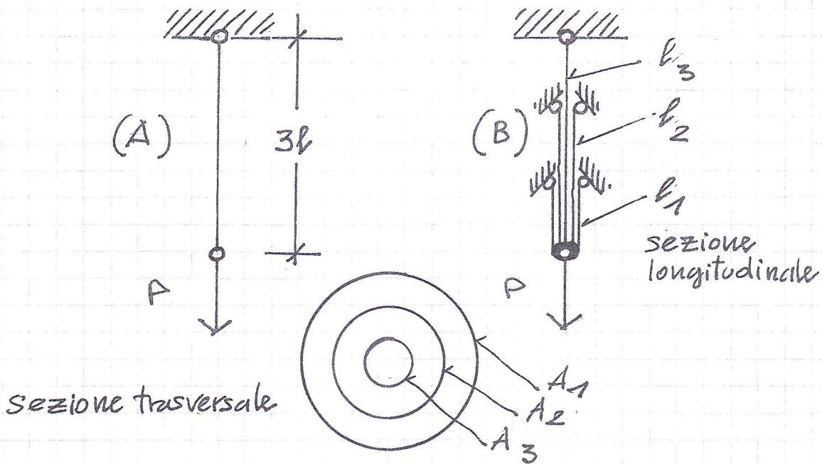
Le asta (A) e (B) sono formate da tre tubi coassiali di acciaio elastico, perfett. e indef. plastico avendo tensione di snervamento  $f_y$ . I tubi hanno sezione trasversale di area rispett.  $A_1, A_2, A_3$  (v. figura).
