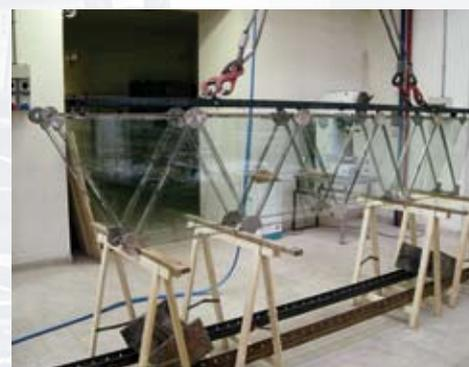
I due ordini di pannelli erano disposti in parallelo ad una distanza reciproca di 25 mm. Al fine di contrastare fenomeni di instabilità flessotorsionale, il lembo superiore della trave è stato munito di un controvento reticolare a doppie maglie di S. Andrea (Figura 5).
